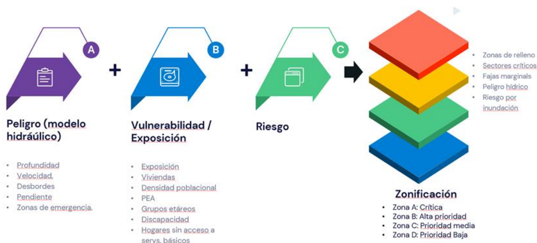
Figura 3-28. Delimitación de áreas de riesgo por inundación
